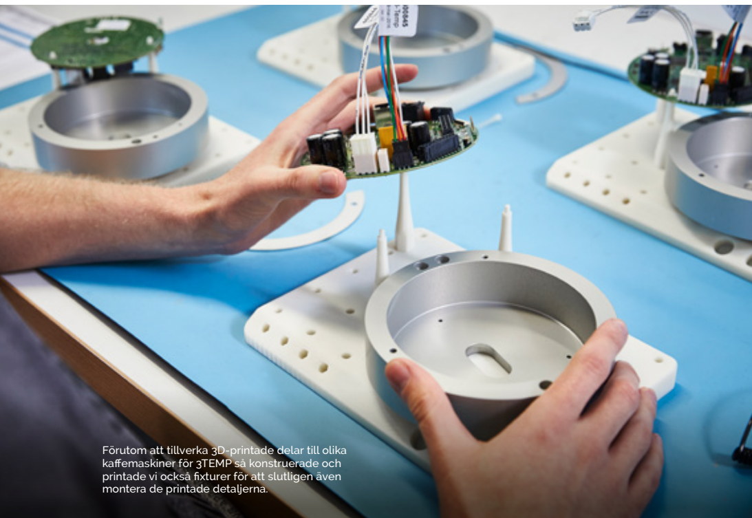
En smart 3D-printad palettfixtur i ABS med FDM-teknik gör det möjligt att montera en detalj från två håll.
